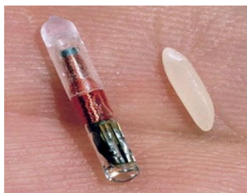
Detail RFID mikročipu v porovnání se zrnkem rýže.
